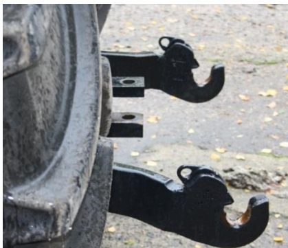
Figur 3. Denne trækbom skal sidde i inderste hul, og adapteren skal ligge på trækbommen uden mellemskiver.
