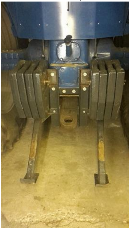
Figur 6. Antitipstænger (Billedet er af en farmstock traktor)
