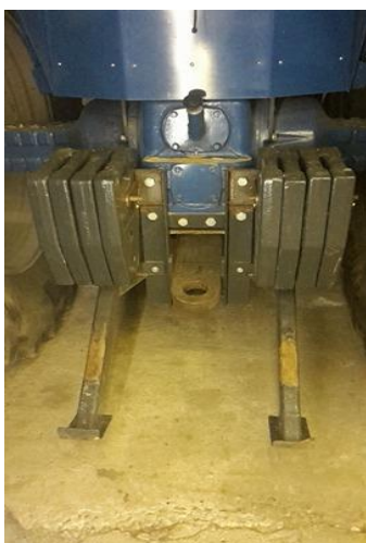
Figur 3. Fast trækpunkt er max. 50 cm over jorden.
