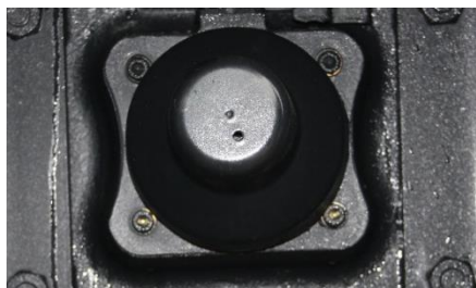
Figur 2. Afskærmet PTO aksel
